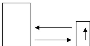
Вертикальная стрелка означает логическое или динамическое преобразование модели внутри себя: доказательство теорем, расчеты, преобразования (например, обдувание модели самолета в аэродинамической трубе) и тому подобное.
